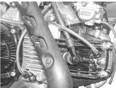
6. バンジョーボルトを規定トルクで締め付けます。
