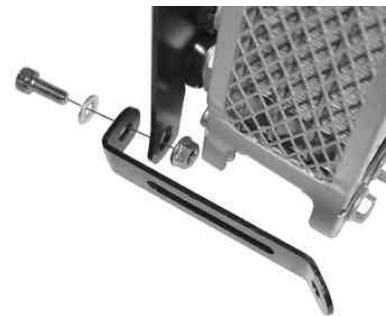
2. L シュラウドの、燃料タンク側のスクリューを仮止めしてから、先程仮止めしたシュラウドブラケットの位置を調整し、L シュラウドに純正スクリューを通して、オイルクーラースター2の裏から、M6フランジナット固定します。
