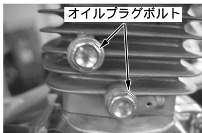
2. バンジョーボルトM10(ロング)に、シーリングワッシャ、バンジョー、シーリングワッシャの順で通し、シリンダー上側のオイルラインに仮付けします。ご使用になる車両のボアアップシリンダーが、ビッグフィンタイプの場合は、バンジョー(30°)を使用して下さい。
