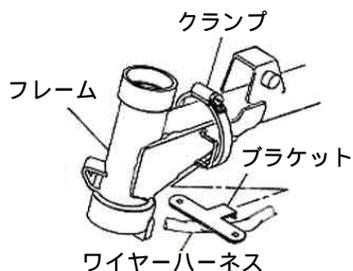
4. 車両のワイヤーハーネスをオイルクーラーブラケットとオイルクーラーの間に通す様にオイルクーラー本体をボタンヘッドスクリュー6×10にスプリングワッシャ、ブレンワッシャの順に通し取り付けます。
