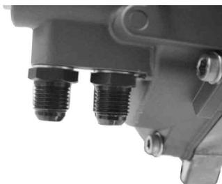
8. アダプターM12にシーリングワッシャ 14 mmを通し、オイルクーラー側のシーリングワッシャがオイルクーラーヘッダー(6角部分の凹部)からずれないように取り付けて締め付けます。
