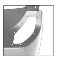
M4で、インテークプレートを固定して完成です。フランジナット M4がカウル内側になります。
