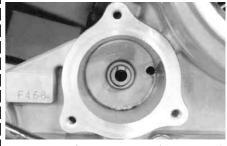
4. 0リング18mmにエンジンオイルを塗 布し、クランクケース奥の突起部外周に取 り付けます。
