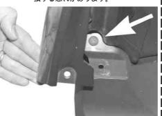
3. ロアレッグシールド底面中央に有るクリップ を外します。
