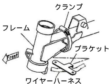
ノーマルステムの場合、ハンドルの切れ角が大きいため、オイルクーラーとステアリングロックが干渉する場合がございます。その際は、ステーの1番大きな穴にバンドを通してフレームに取り付ける事でクリアランスを確保して下さい。(フレームの平らな場所の後端よりも後ろに取り付けます。)
