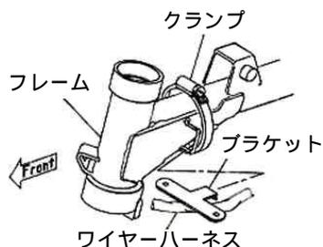
ノーマルステムの場合、ハンドルの切れ角が大きいため、オイルクーラーとステアリングロックが干渉する場合がございます。その際は、ステアの1番大きな穴にバンドを通してフレームに取り付ける事でクリアランスを確保して下さい。（フレームの平らな場所の後端よりも後ろに取り付けます。）
