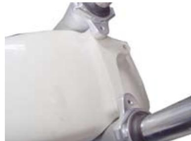
○タイヤとの干渉を見ながら高さを調整し、写真の位置を参考にホルダーをダストシールの下に固定して下さい。
