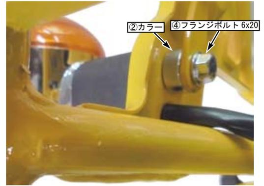
∴作業スペースがとて狭い為、④フランジボルト 6x20 の締め付けは、出来るだけ小形の工具を使用される事をお奨めします。
