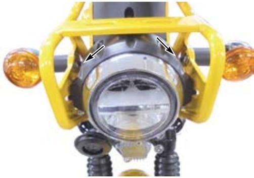
○工具が入らない等で、フロントウインカーボルトが外せない場合は、ヘッドライトケースを固定しているボルト2本を外し、ヘッドライトケースを一旦外してから、フロントウインカーボルトを取り外します。
