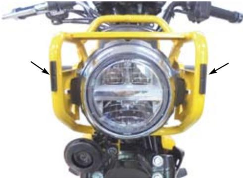
○①ヘッドライトガード COMP. の取り付け穴とフロントウインカーの取り付け穴を合わせた際、③ラバーが①ヘッドライトガード COMP. を支えられる位置になるよう調整します。
