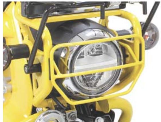
○①ヘッドライトガード COMP. 及び車両の個体差により、③ラバーと①ヘッドライトガード COMP. の間に隙間が生じる場合は、⑤ラバープレート を適度なサイズにカットし、ヘッドライトステーと③ラバーの間に貼り付けて、調整して下さい。
