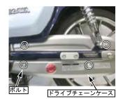
〇下の写真の位置に①アルミチェーンガードを取り付け、 ②フランジボタンヘッドスクリューを規定トルクまで 締め付けます。
