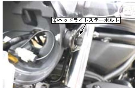
○ヘッドライトユニットの上側を斜め下からヘッドライトケースにひっかけ、元ついていた樹脂ワッシャ、M5x16 左右 2ヶ所を締め付けます。
