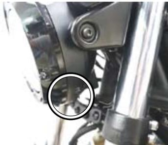
○ヘッドライトユニットの爪を取り外し下側にヘッドライトユニットをずらす事で外れます。
