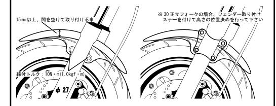
ABS 及び AES 製は FRP 製品とは異なり、飛び石によるエッジ部分の割れや、衝撃などにも強いのが特徴です。 当社製/ φ 27 正立フロントフォークキット/ φ 27 正立フロントフォークキット (タイプ 1) /φ30正立フロントフォークキット 装着車用になります。
