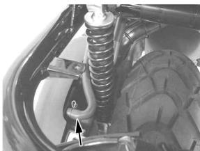
5. クッション1の粘着テープを剥し、マッドガードCOMPに貼り付けます。貼り付けた後、クッション1を強く押さえて付けて下さい。
