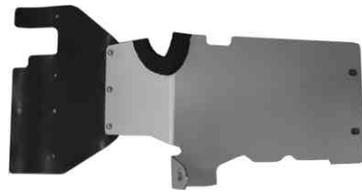
6. マッドガードCOMPをリヤタイヤとエンジンの間にはめ込みます。この時(5)でクッション1を貼り付けた切欠き部にエアクリナーコネクティングチューブが、はまる様にします。
