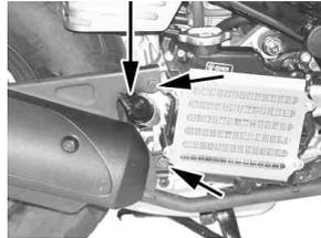
3. シートしたのフロアパネル固定ボルト4本を外します。フロアパネル後部分を跳ね上げ、フレームパイプにビニールテープ等で固定して下さい。
