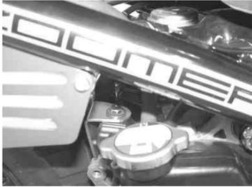
10. (7)(8)で仮止めたボルト類を フランジボルト、 フランジソケットキャップスクリューの順で締め付けます。
