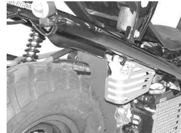
7. クランクケース後方下部の穴にラバーナットをはめ込み、ステーをフランジソケットキャップスクリューにて仮止めます。
