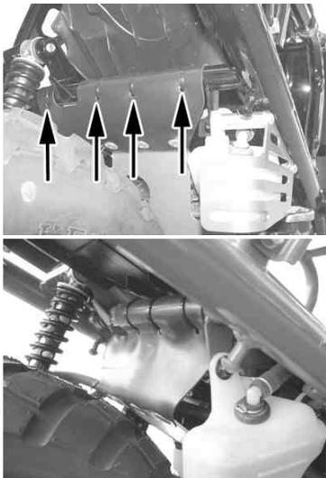
12. クッション2の粘着テープを剥し、(11)でフレームに巻きつけたラバーの上に貼り付けます。貼り付けた後、クッション2を強く押さえて下さい。
