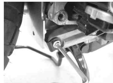
8. マッドガードCOMP. の下側2箇所 の穴に フランジボルトを通し、ステーに仮止めます。
