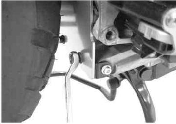
9. マッドガードCOMP. の右上穴部をリヤフェンダー取り付け部に載せ、STDボルトで固定します。
