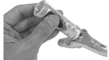
ブレーキペダルCOMP にペダルカラーを差し込み フットレストをペダルカラーの位置決めピンをフットレストを差し込みます。チェンジペダルCOMP も同様にペダルカラー、フットレストを差し込みます。ペダルカラーとフットレストは、はめ合い交差になっていますので、フットレストをペダルカラーに真っ直ぐ差し込んで下さい。
