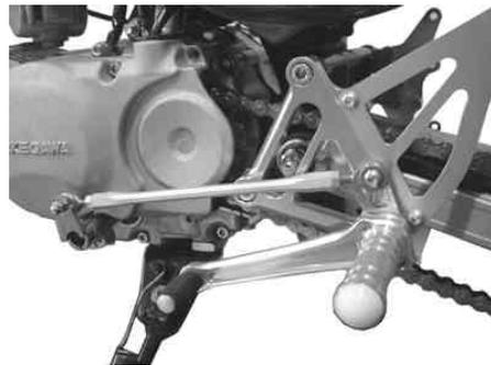
反対側のロッドエンドもチェンジペダル C O M P . にボタンヘッドスクリューを用いて取り付け締め付けます。
