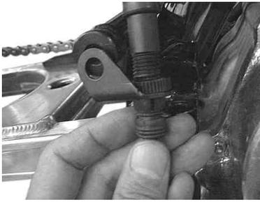
ストップスイッチステ - にリヤ - ストップランプスイッチを取り付けます。
