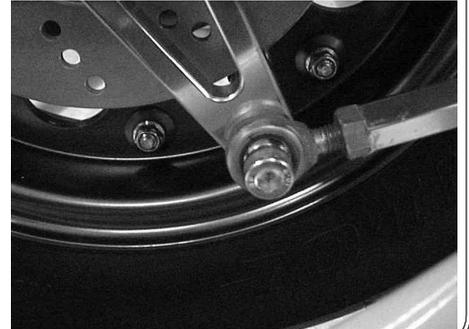
トルクロッドをフレームに取り付けたトルクロッドブラケットとキャリアブラケットにソケットキャップスクリューM8 X 25を用いて取り付け締め付けます。
