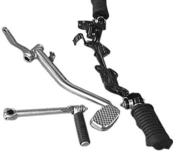
STD ブレーキペダルCOMP のブレーキロッドを止めているワリピン、ブレーキリターンスプリング、ストップスイッチスプリング、ブレーキペダルを止めているワリピンを、それぞれ外し、STD ブレーキペダルを取り外します。
