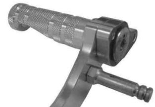
ブレーキペダルCOMP 裏側のタップ部にスプリングフックを取り付け締め付けます。
