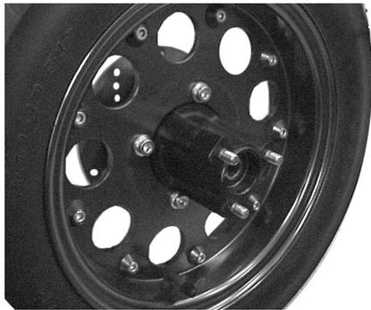
リヤホイールにリヤハブASSY.をホイールKIT付属のフランジキャップスクリューを用いて取り付け締め付けます。(エアバルブがディスクローターと反対側になる様)
