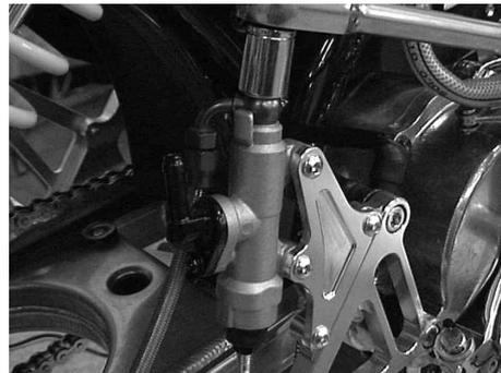
フルボトムしてもブレーキホースCOMP.がつかばらない様ホースを取り直し、バンジョーボルトを規定トルクで締め付けます。
