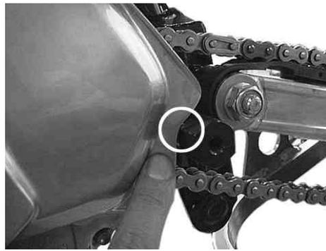
取り外した左クランクケ - スカバ - をマウントナットに干渉する部分をリューター等で干渉しない様、加工します。(加工後は、バリやカエリが無い様ヤスリ等でエッジ部を面取りして下さい。)
