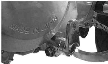
K I T 内のチェンジア - ムを上向きに取り付け締め付けます。
