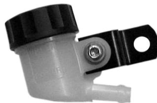
オイルカップCOMP.にリザーバータンクステをブレンワッシャボタンヘッドスクリューを用いて取り付けます。
