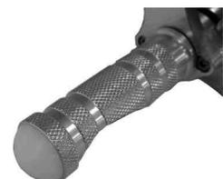
キット内のフットレストエンドをプラスチックハンマー等を使用してフットレストに打ち込みます。
