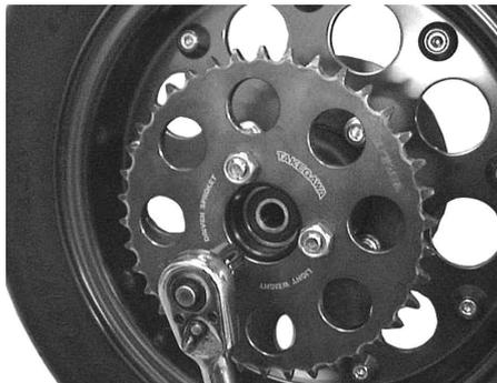
リヤハブASSY.にドリブンスプロケットをSTDナットを用いて取り付け締め付けます。
