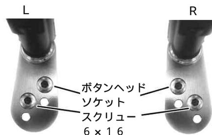
8. 各部をもう一度規定トルクで増し締めし、確認を行って下さい。
