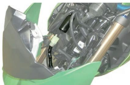
13. メーターバイザーへ印をつけた位置に、ウェルナットを取り付けする為の穴をあけ、ウェルナット M6×1.0を差込みます。
