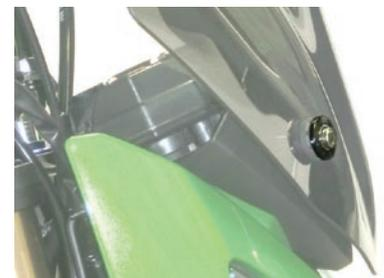
16. スクリーンが車体に対してまっすぐになっているか確認・調整しながら、スクリーンステー両端のキャップナットと、フロントプレートのキャップナットを締め付け、スクリーンを固定します。
