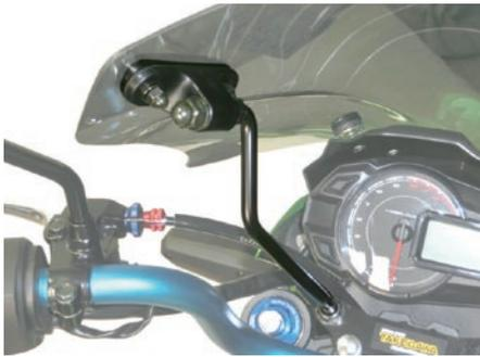
9. 仮付けたスクリーンの位置が車両のセンターになるように確認しながら、メーターバイザーとカラー(クッションラバー用)の間にカラー(ブラックアルマイトの物)を挟み、メーターバイザーへの穴あけ位置を決め、印などをつけます。
