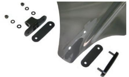
7. 車両に取り付けたスクリーンステーのネジ部分に、左右とも1個ずつプレーンワッシャ M10を通しておきます。
