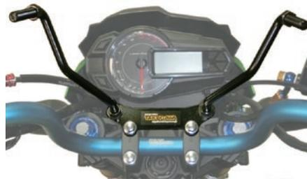
4. 後側2本のスクリューを一旦緩めてから、ハンドルパークランプのスクリューを規定トルクで締め付けます。
