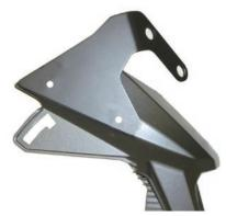
4. ヘッドライトカバーにつけた印の位置に、 直径 6mm の穴を左右 2 箇所ずつ、計 4 箇所 あけます。
