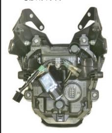
7. ヘッドライトカバーにヘッドライトサイドカ バーを取り付け、おおよその光軸位置に合わせ た上で、一旦車両に仮組みし、スクリーンステー の穴にウェルナット M5x0.8 ロングタイプを 4 箇所取り付けます。
