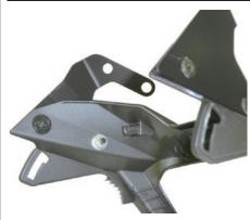
6. ヘッドライトカバーにヘッドライトユニット ASSY. を組み付けます。
