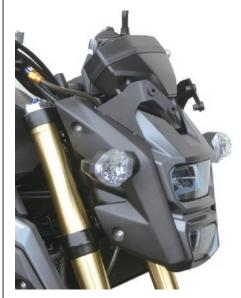
8. スクリーンステーに取り付けたウェルナットの ネジ穴と、スクリーン(ショート・スモーク) の穴位置を合わせて、ボタンヘッドソケットス クリュー 5x20(黒クロメート)4本にて固定します。
