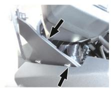
9. 仮組みで問題がなくなれば、ヘッドライトカ バー及びヘッドライト ASSY. を、分解した逆手 順にて車両に元通り取り付けます。
