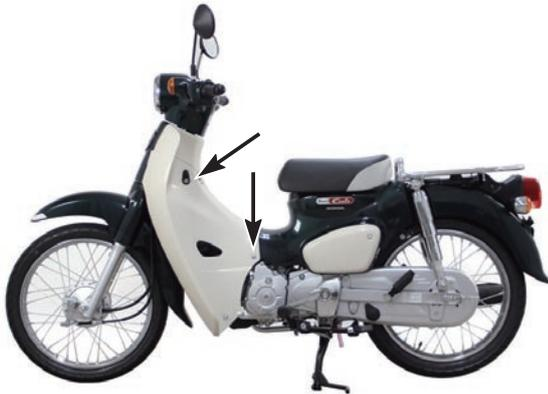
2. 車両のレッグシールド上面をウエス等で養生しセンターキャリア COMP. を載せ、図を参照し車両前方側2箇所を先に仮付けします。
