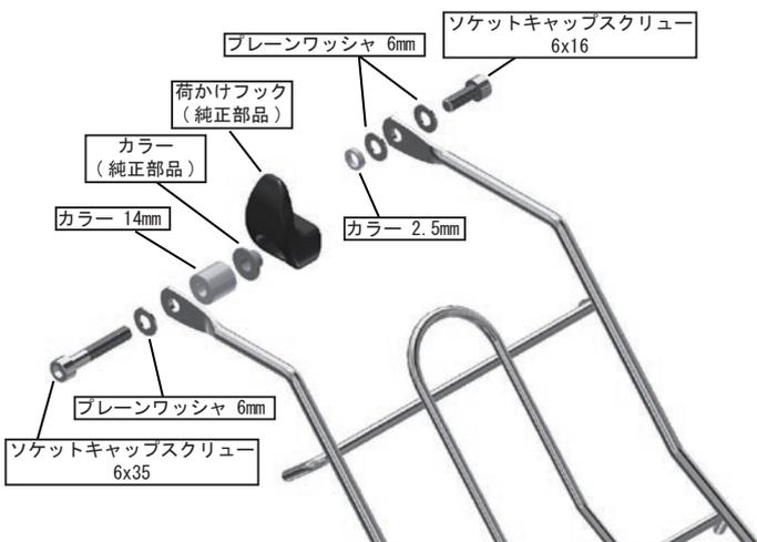
3. 図を参照し、L. ステー（短い方）をセンターキャリア COMP. 後ろ側のステー部に仮付けします。
