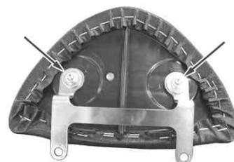
8. ボタンヘッドスクリーンを用いてバックレストASSY.を取り付け、規定トルクで締め付けます。
