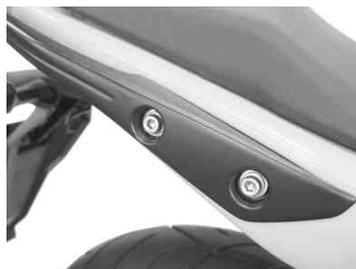
フックを付属のボルト8 x 90で規定トルクにて締め付けます。
