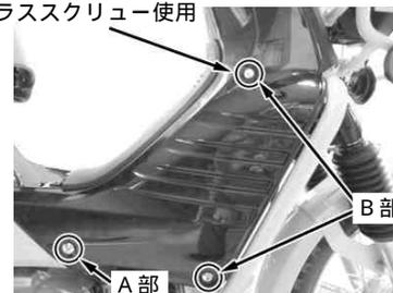
取り付けが完了すればフロントカバーをハーフカバーに組み付け、取り外したスクリーンで締め付けします。
