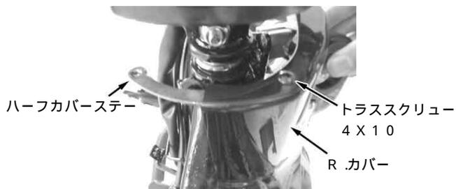
L .カバーをトラススクリュー 4 X 1 0 を使用し取り付け締め付けます。この時ハーフカバーの合わせ面同士を隙間の無い様に合わせ、本締めを行って下さい。
