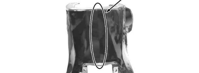
ハーフカバーの組み付けが完了すればレッグシールドを取り付けていた純正のスクリュー 6 X 1 2 とキット付属のトラススクリュー 6 X 1 2 を使用し、各箇所を締め付けます。
