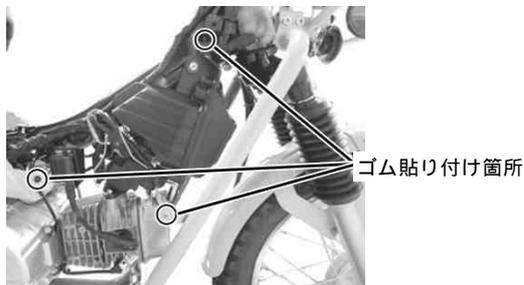
純正のR .レッグシールドに取り付けられているキーシリンダーラバーを取り外し、キットのR .カバーに組み付け、付属の丸型ゴム 3.7 mm をR .カバーの内側になる様、組み付けます。
