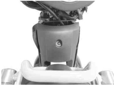
メインパイプカバー、センターカバーを組み付け、各スクリーンを締め付けます。
