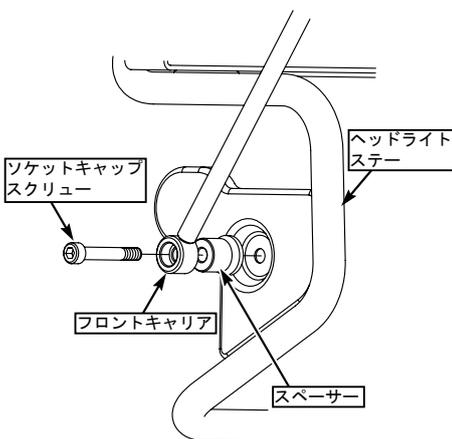
○ヘッドライトステー上部にある長穴2個の裏側に、キット内のナットを図の様に嵌め込み、フロントキャリア ASSY. のステー部の穴にキット内のフランジボタンヘッドソケットスクリューを用いて仮締めをする。
