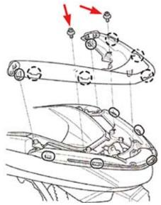
グラブレールカバーを外側に押し、溝部を グラブレール突起部から外し、グラブレール カバーを取り外します。
