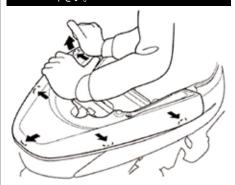
○グラブレールカバー裏面の4ヶ所の穴に合わせてカバーにケガキ線を入れてスクリューを 外し、カバーを取り外します。
