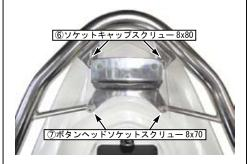
○③ステーに②バックレスト ASSY. をセットし、 ⑧フランジナット 8mm を用いて取り付け、規定 トルクで締め付けます。
