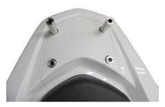
○後方に⑥ソケットキャップスクリュー 8x80、 前方に⑦ボタンヘッドソケットスクリュー 8x70 を用いて、①グラブバー COMP. 及び③ステーを 取り付けます。
