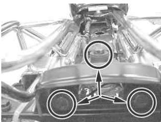
5. リアキャリアのmountボルト4本を外しリアキャリアを取り外します。
