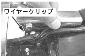
3. ウィンカーステーをテールライトケースの奥側にあたる部分にSTDボルト2本を使用し、ウィンカーステー上部には、カラー、ブレンワッシャ、フランジボルトを用いてウィンカーステーを取り付け、締め付け、ウィンカーの配線を接続します。
