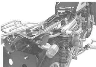
2. ツールBOXを取り付けているキャップナットを取り外し、ツールBOXを取り外します。
