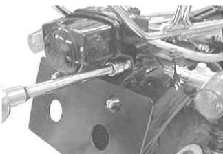
4. 左右のウインカーの配線を外し、テールライトケースの奥の2本のボルトとウインカー上部の1本のボルトを外し、ウインカーを取り外します。
