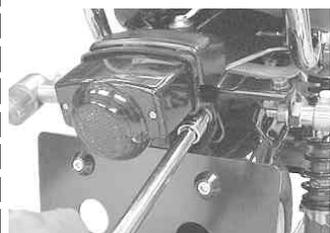
5. ワイヤハーネスの接続部分にブーツをきちんとかぶせ、ワイヤークリップで固定します。
