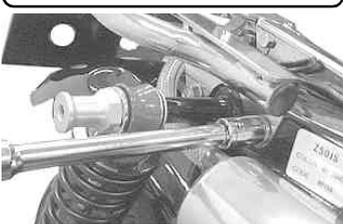
2. グラブバーにワイヤークリップを付属の六角ボルトで取り付け、ワイヤハーネスを固定します。
