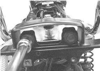
4. テールライトケースの配線をクラブバーの長穴部分から下方にやり、ウインカーステーにSTDボルト2本を用いて取り付け、締め付け配線を接続します。
