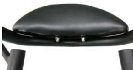
○①グラブバー COMP. を③フランジソケットキャップスクリュー 8x40 を使用し、車両に取り付けし、規定トルクにて締め付けます。
