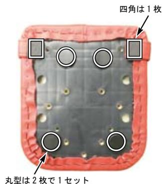
○写真に丸印してある取り付け穴を使用し、ボルト、ステー、スチールスペーサーの順番で、純正リアキャリアにピリオンシートを取り付けます。ステーは純正リアキャリアを車体に取り付けた際に、コの字の口が開いている方が車体側になるように取り付けます。
