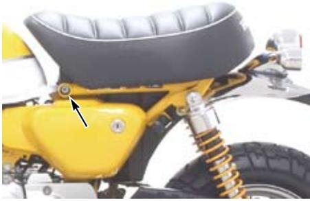
○リアショックのアップマウントナットを外して、フレーム側のワッシャを左右より各1枚取り外します。
