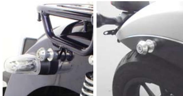
※スーパーカブ C125 は、ネジ部破損防止の為、キャリアの穴とリアフェンダーのネジ穴の位置を確実に合わせ、取り付けして下さい。
