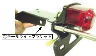
○①テールライトブラケットに②ウインカーステーを④ボタンヘッドソケットスクリュー8x16、⑤フランジUナット8mmにて仮止めし、ウインカーを純正ボルトで②ウインカーステーに取り付ける。
