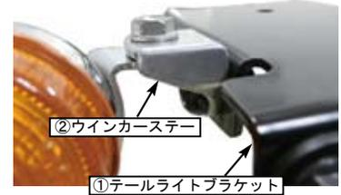
○テールライトブラケットの裏側に③ワイヤークリップを⑥フランジ六角ボルト6x15、⑦六角ナット6mmにて取り付ける。
