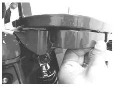
〇リアショック上部のナット、ワッシャを取り 外し、①サポート COMP. をリアショック上部の ピボットにセットします。
