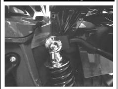
〇テールランプロアカバー左側の③ソケット キャップスクリュー 6x40 を締め付けます。
