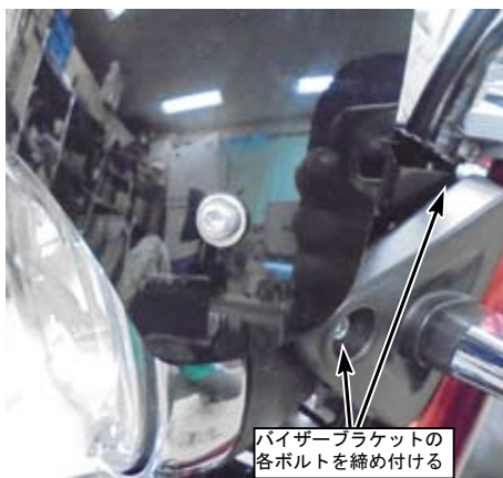
バイザーブラケットの各ボルトを締め付ける
