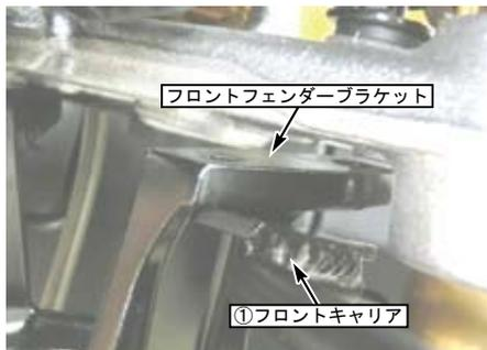
○①フロントキャリアの下側を、フロントフェンダーブラケットを取り付けていた純正ボルト4本で、フロントフェンダーブラケットと共付けします。この時ボルトは2山～3山掛かる程度にしておきます。ボルトが入りにくい場合は、①フロントキャリア側を少し内に縮めながら、ボルトを差し込んで下さい。
