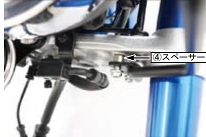
○フロントキャリアの仮付けが完了したら、干渉が無いか確認し、問題無ければ規定トルクで締め付けます。
