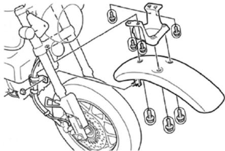
○ヘッドライトケースを留めているボルト2本を取り外し、その箇所に②段付きカラー及び③ソケットキャップスクリュー 6x30を使用し、①フロントキャリアを仮付けします。
