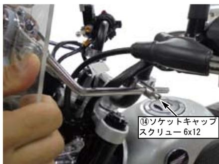
○各部を調整し、角度の調整やクリアランスを確保し、各ボルトを締め付けます。
