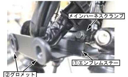
○ホーンを元の箇所に戻し、規定トルクで締め付けます。
