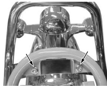
※切り欠き部をリアショックのアップマウント部に差し込む際、車体及び製品に個体差があり、幅が狭いと感じた時は、切り欠き部を左右に若干広げる様にし、アップマウント部に差し込んで下さい。
