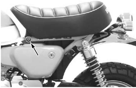
○リアショックのアップマウントナットを外して、フレーム側のワッシャを1枚取り外します。（左右共）
