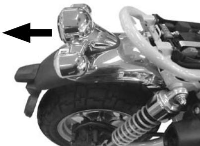
○①リアキャリア COMP. の切り欠き部を、先ほどワッシャを外したリアショックのアップマウント部に差し込み、②フランジソケットキャップスクリュー 8x16 と③フランジナット 8mmにてフレームに取り付けます。
