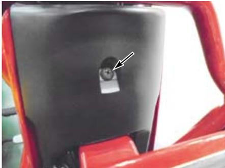
○写真を参考にノーマルのホーンステーを固定していたフランジボルトを使用し①ステー1を規定トルクで取り付けます。
