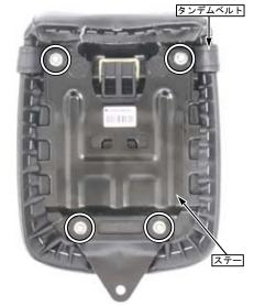
〇シートにシートカバーを取り付け、シワにならない様に シートカバーを引っ張り紐を締め上げます。 この際、紐を引く方向は画像を参考にして下さい。
