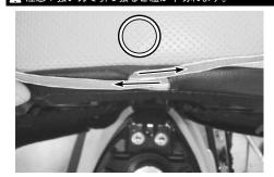
▲ 注意:下の写真の方向で紐を引くとシートカバーが 破損します。
