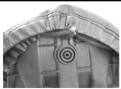
○商品に同梱しているタンデムベルトを取り付け、 ステーを戻し、純正 M6 ナットで締め付けます。
