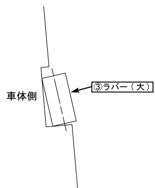
○③ラバー（大）が落ちない様に注意しながら、①ロングスクリーンを軽く車体に押し当て、②ボタンヘッドソケットスクリュー 5x35と⑤プレーンワッシャを使用し、仮留めします。
