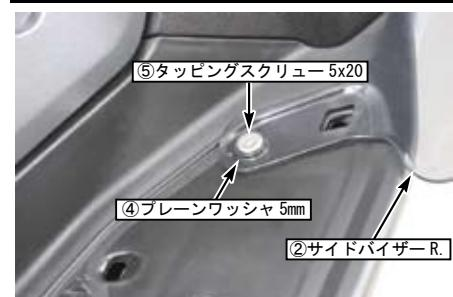
○①サイドバイザーL. も同様に行い完了すれば、フットレストボードのマットを逆手順で戻します。
