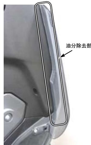
○②サイドバイザーR. の貼り付け箇所が分かれれば、剥離シールを外し軽くカウルに貼ります。
