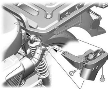
○リアキャリアの微調整が可能な様にサービスマニュアルを参照し、マフラーを取り外しリアクッションアッパーマウントナット及びリアキャリア取り付けボルト2本を緩めます。
