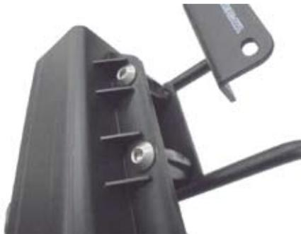
○①ブラケット COMP. をリアキャリアにセットし、④ソケットキャップスクリュー 6x12 を用いて仮止めをします。
