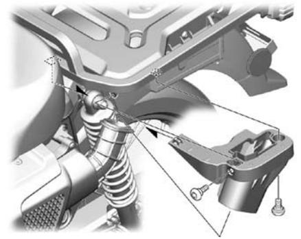
※ツールボックスの開閉カバーと車両リフレクター部が触れる場合、カバーを若干車両外側に引っ張り開閉を行って下さい。
