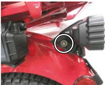
○①ブラケットCOMP. をリアキャリアにセットし、純正ツールボックス、⑥ツールボックスカラーを通して④ソケットキャップスクリュー 6x60 を用いて仮止めをします。テールランププロアカバー部分のカラーが脱落していない事を確認し、③ソケットキャップスクリュー 6x40 を仮止めします。
