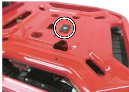
○①ブラケットCOMP. 組み付け後、リアキャリア取り付けボルトを締め付けます。
