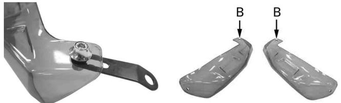
7. ソケットキャップスクリューLに、リテーナーLを通して組み付け、グリップカウルに取り付けたステ - L の穴に通し、ハンドルエンドカラー、ストップラバー、フランジナットの順に組み付け、ストップラバーに当たるまでフランジナットを手で仮締めします。
