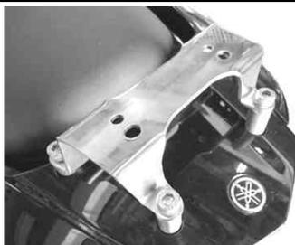
7. 取り付けしたソケットキャップスクリュー4本にボルトキャップを装着します。
