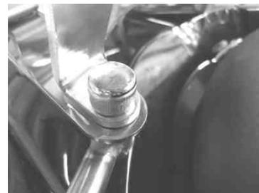
4. ステーにバックレストASSY.をセットし、ブレンワッシャとフランジ袋ナットにて取り付けます。
