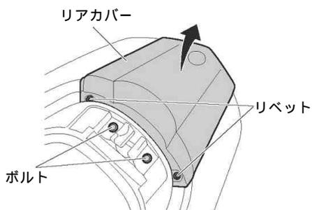
3. リアカバーを外し、ブラケットを固定しているボルト4本を外します。
