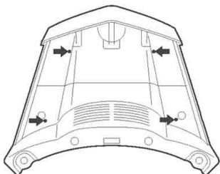
5. リアカバーとリベット2個を元の箇所に取り付け、シート下のボルト2本を締め付けます。
