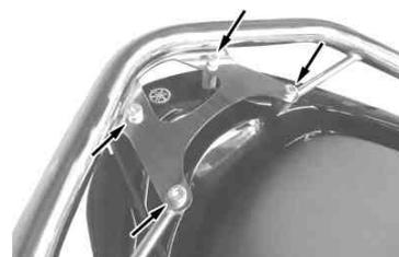
2. ステーをセットし、ソケットキャップスクリュー8×60にて取り付けます。
