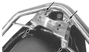
3. 取り付けしたソケットキャップスクリュー4本にボルトキャップを装着します。
