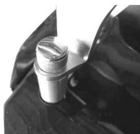
8. ステーにバックレストASSY.をセットし、ブレンワッシャとフランジ袋ナットにて取り付けます。
