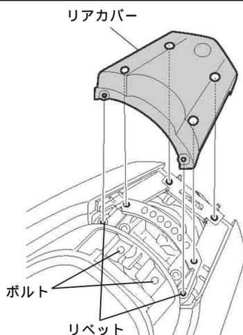
6. リアカバーの4箇所穴にキット内のカラー4個をセットし、ステーをソケットキャップスクリューにて取り付けます。
