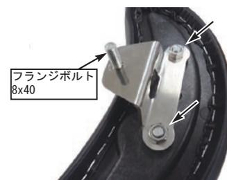
5. ステーを取り付けたバックレスト ASSY. を、フランジボルト 8x40 にてグラブバー ASSY. に取り付け、規定トルクで締め付けます。
