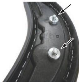
4. ステーの穴にフランジボルト 8x40 を通した状態で、六角ナット 8mm を用いてバックレスト ASSY. に取り付け、規定トルクまで締め付けます。
