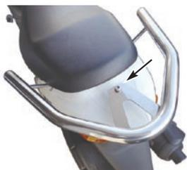
3. バックレスト ASSY. 裏面のスタットボルトにカラー 1 をセットします。
