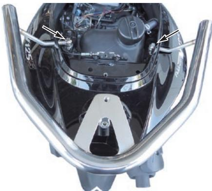
7. バックレスト ASSY. 裏面のスタットボルトにカラー1をセットします。
