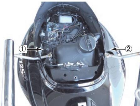
5. グラブバー ASSY. とブラケットのネジ穴を合わせ、ソケットキャップスクリュー8x25を規定トルクまで締め付けます。
