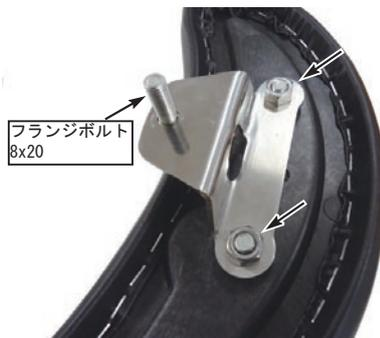
9. ステーを取り付けたバックレスト ASSY. を、フランジボルト8x20にてグラブバー ASSY. に取り付け、規定トルクまで締め付けます。
