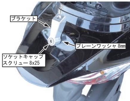
4. グラブバー ASSY. を車両にセットします。その際、グラブバー ASSY. のステーを左右の順に差し込みます。
