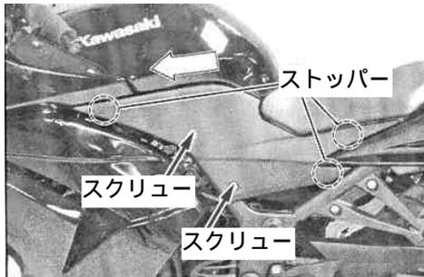
フロントシートのボルトを外し、シートを後方に引き抜き取り外します。
