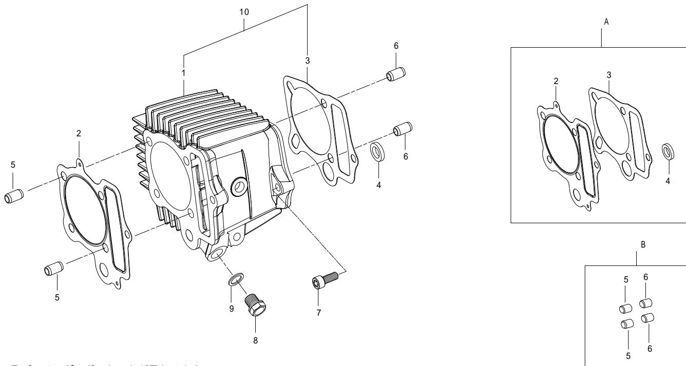
注) エンジン号機により、シリンダー及びシリンダーガスケットが異なります。
