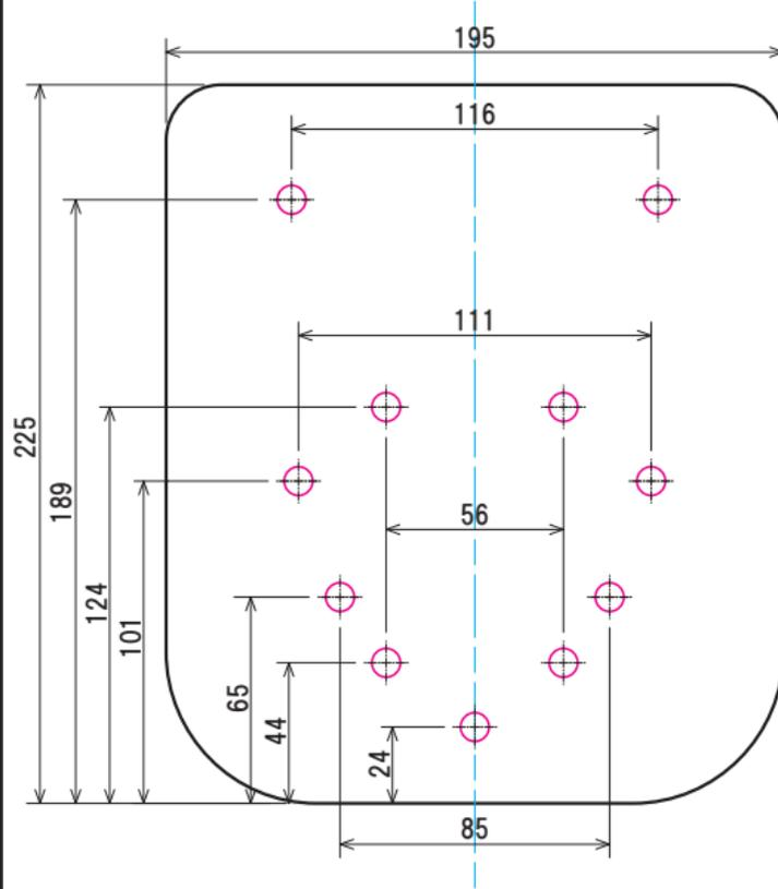
各部にあるネジ部と汎用性のある固定プレートにより、いろいろなレイアウトでシートとキャリアを固定出来ます。
