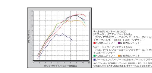
テスト車両:モンキー125(JB03) Sステージαボアアップキット145cc (FIコン TYPE-X/フューエルインジェクター(G-1)付属) +エアフィルター (別売) +スポーツマフラー ■N-20カムシャフト ■N-10カムシャフト Sステージαボアアップキット145cc (FIコン TYPE-X/フューエルインジェクター (G-1) 付属) +スポーツマフラー ■N-20カムシャフト ■N-10カムシャフト ■ノーマルエンジン+ノーマルカム+ノーマルマフラー ダイノジェットによる後輪出力データは、実走行とは異なります。測定時
