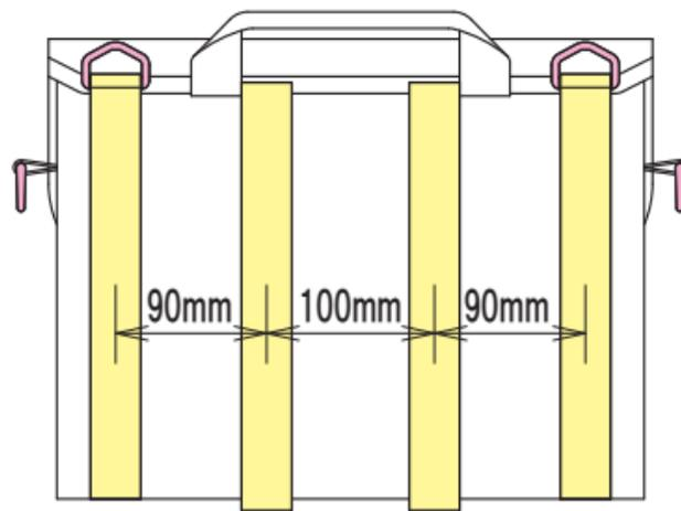
バッグ背面 面ファスナー式固定ベルト4カ所
