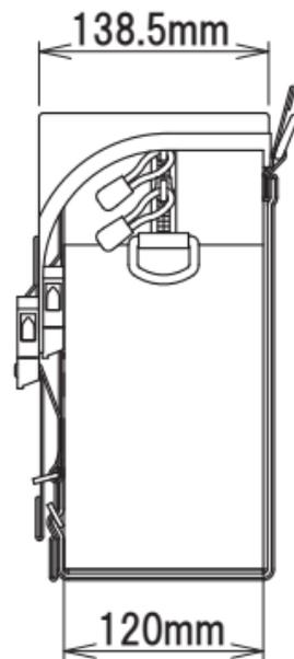
スリングベルト取付け用Dリング4カ所
